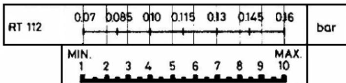
Рисунок 3: График регулировки дифференциального диска
