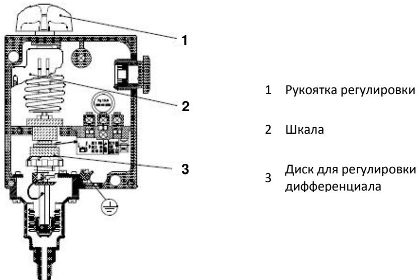
Рисунок 2: Реле давления серии RT
