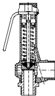
Сила, которая уравновешивает давление пара и удерживает закрытым прерыватель в спускном отверстии, передается пружиной.
